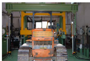
Figura 10. Fasi della prova. Da sinistra verso destra: spinta laterale, schiacciamento e spinta longitudinale
