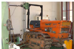
Figura 10. Fasi della prova. Da sinistra verso destra: spinta laterale, schiacciamento e spinta longitudinale
