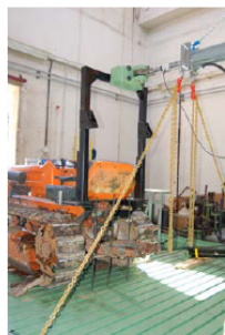
Figura 10. Fasi della prova. Da sinistra verso destra: spinta laterale, schiacciamento e spinta longitudinale
