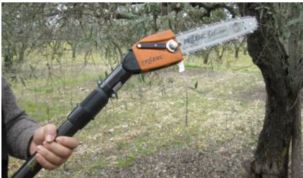
▲ Motosega montata su asta per una potatura di riforma o di rami di diametro superiore a 5-6 cm.
