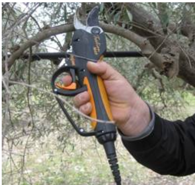
▲ Le forbici pneumatiche ed elettriche consentono di migliorare la qualità dell'intervento cesorio e riducono i tempi di esecuzione.
