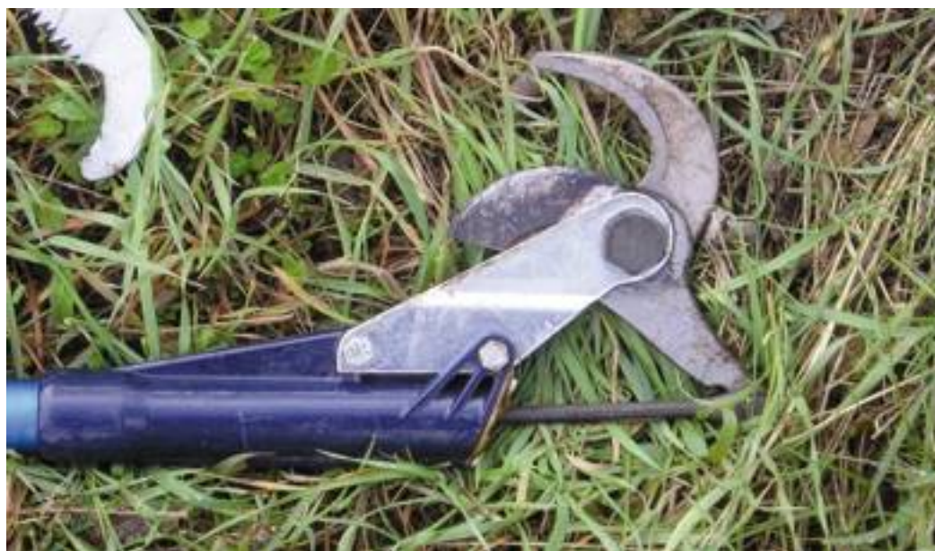
▲ Particolare di troncaremi pneumatico con organo di taglio conformato a uncino.
