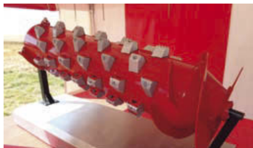
■ Il nuovo rotore Small Tube equipaggerà le mietitrebbie Axial Flow delle serie 140 e 240.
