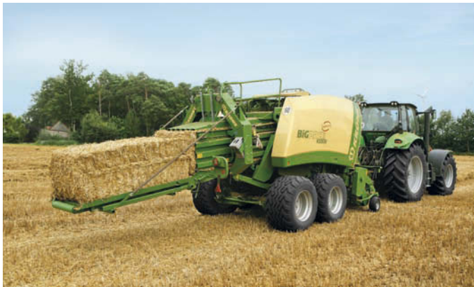
■ La Big Pack 870 HDP HighSpeed consente di produrre grandi balle nel campo e di dividerle fino a 9 piccole balle in azienda.
