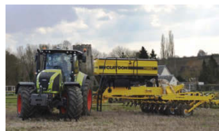
■ La Claydon Hybrid T ha due linee di denti distanziate 2,5 m.
