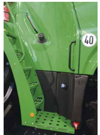
■ Serbatoi collocati più in basso rispetto alla serie precedente (quello dell'AdBlue contiene 40 litri).
